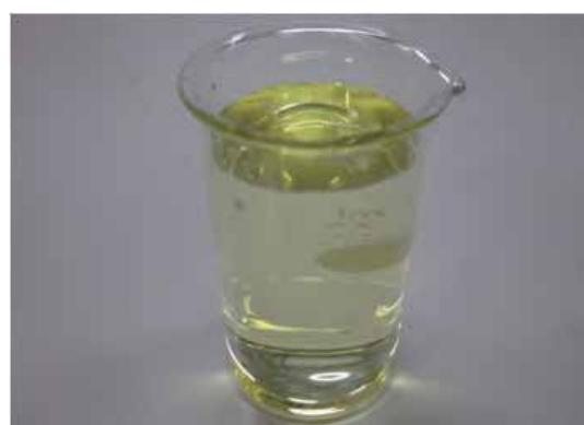
図 3-2 亜硝酸リチウムの外観
