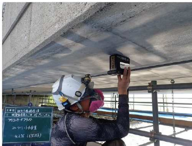
写真 4-3 コンクリート表面水分率の測定状況
