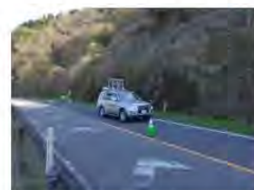
MMS※1を活用した 斜面・のり面点検
