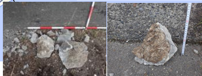
剥落したモルタル片(最大Φ50cm)
