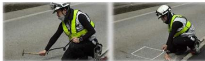
手作業による損傷の検出
