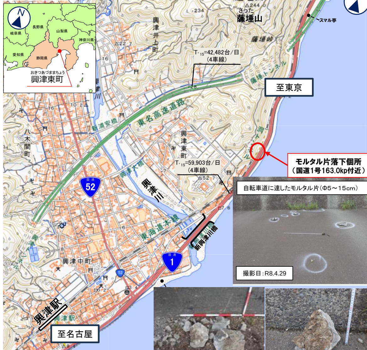
剥落したモルタル片(最大Φ50cm)
