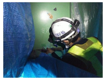
磁粉探傷試験※
