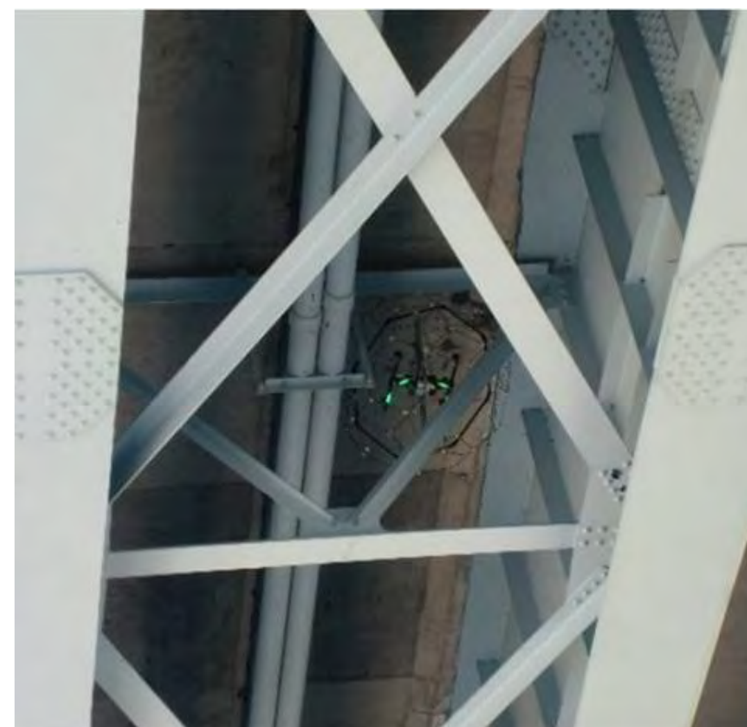
橋梁の打音検査や近接目視を代替するドローンの例
