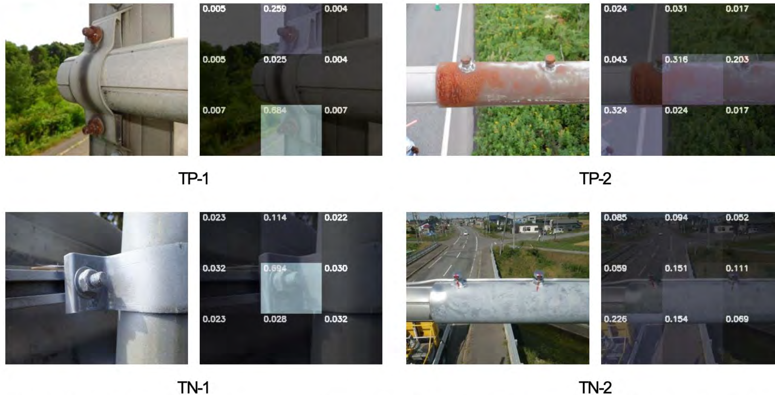
図-7 モデルが正しく判定した画像とその Attention の例. 上段は「腐食あり」の画像を表し，下段は「腐食なし」の画像を表す. また，Attention 中の数字は実際に推定された Attention の値を表し，0 から 1 の値で推定されている.
