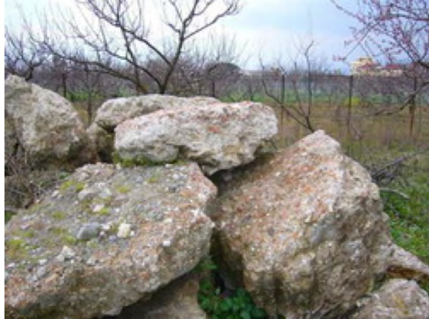
古代ローマ(約2000年前)コン クリートの研究用大型試料
