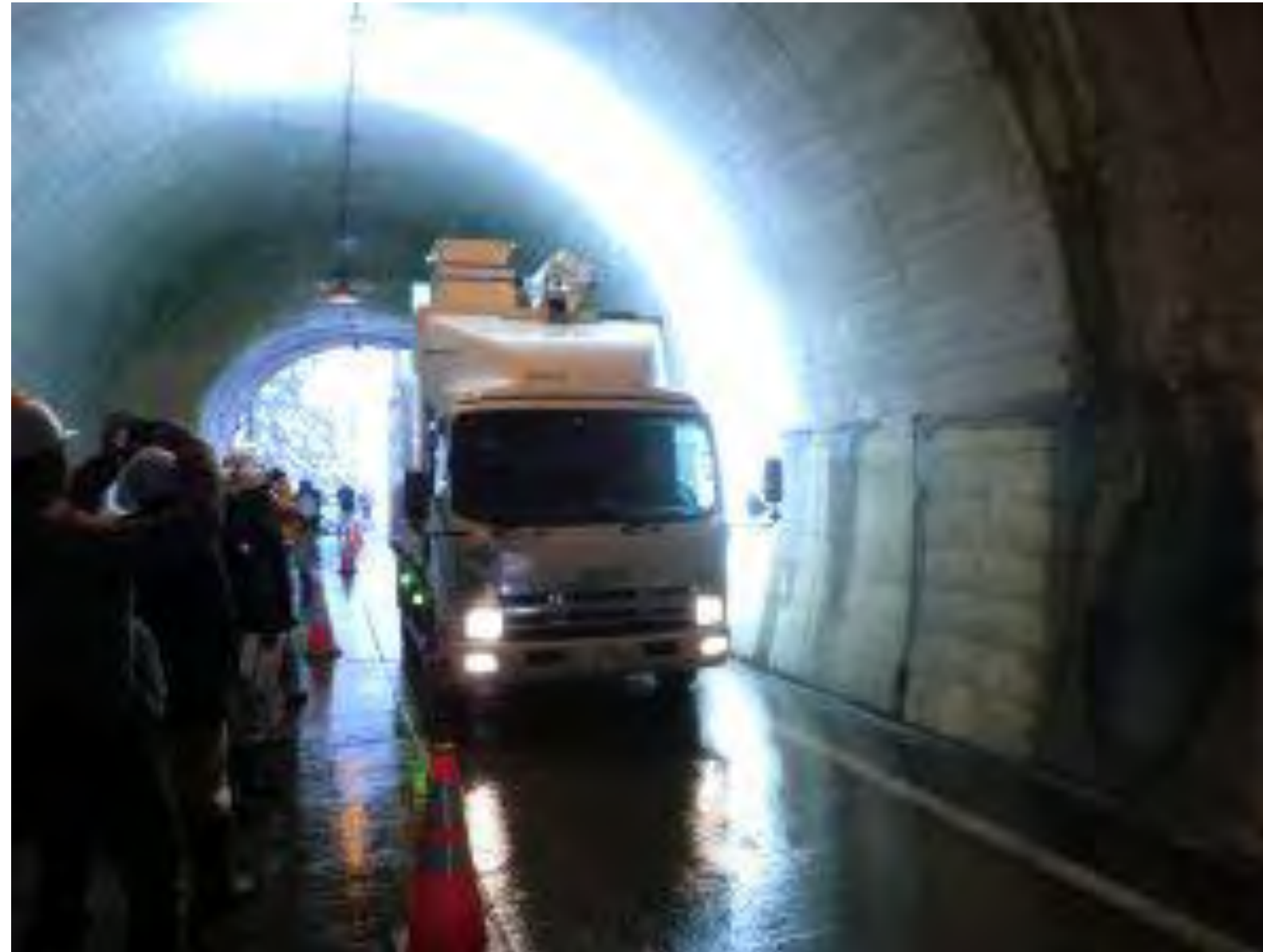
高速走行型非接触レーダーによるトンネル覆工の内部欠陥点検
