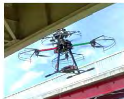
▲ 橋梁の損傷写真を撮影する技術
