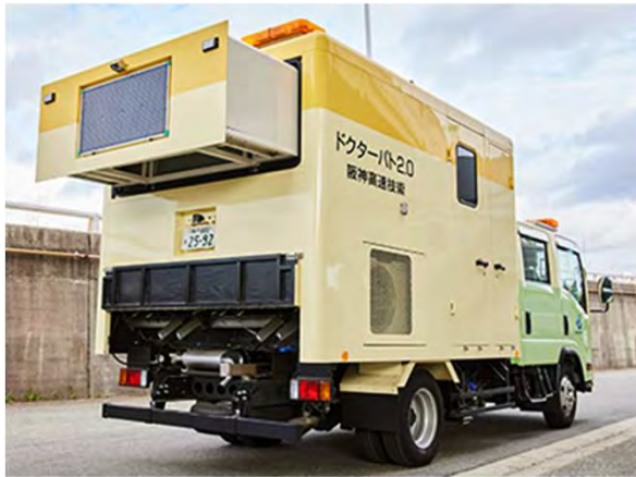
路面・トンネル点検車（ドクターパト2.0）
