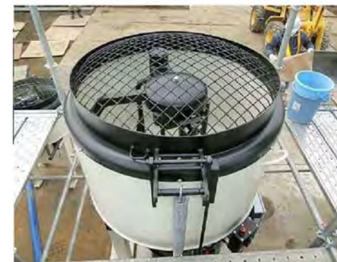
高粘性のため 専用のミキサー を使用
