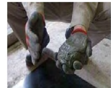
材料を手で持ち運びできる 高粘性と材料分離抵抗性 を有する
