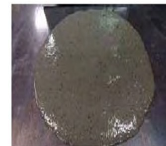
材料を手で持ち運びできる 高粘性と材料分離抵抗性 を有する
