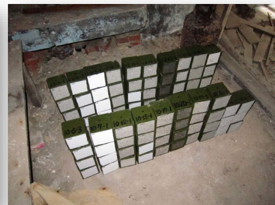
17号棟居室内 (飛来塩分がない環境)
