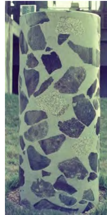
北備讃瀬戸大橋2Pのコア（ \Phi 45\text{cm} ） →十分な強度、品質を確認
