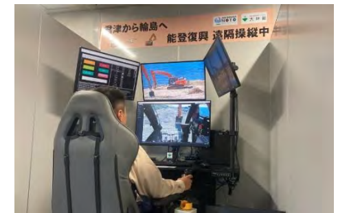
遠隔操縦状況（操縦室内の操縦席）
