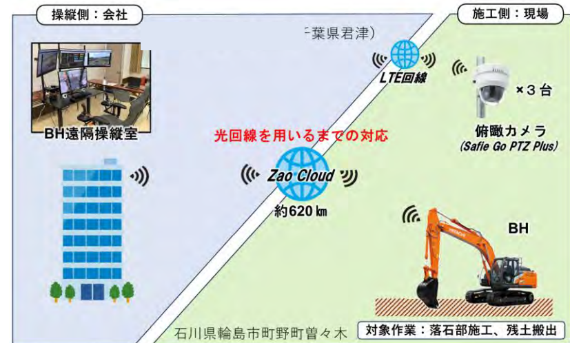
遠隔操縦概要図（（株）大林組提供）
