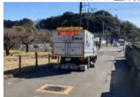
（空洞探査車による調査）
