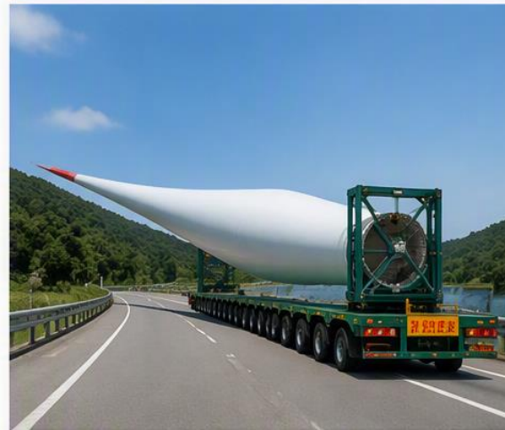
風力発電部材を運ぶ超重量車 (ブレード・タワー等の輸送)
