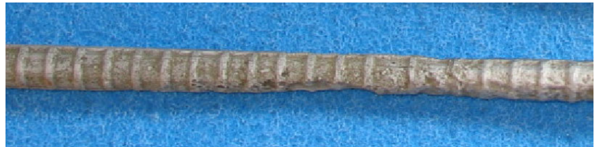
塩害劣化部材中の腐食鉄筋
