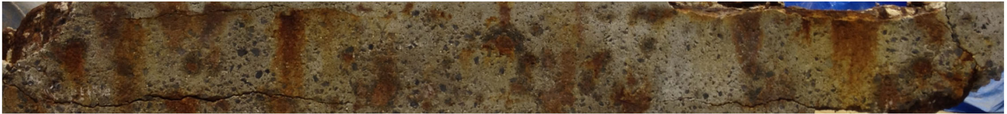
塩害劣化部材中の腐食鉄筋
