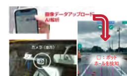
スマートフォンで取得した画像による ポットホール検知
