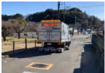
（空洞探査車による調査）
