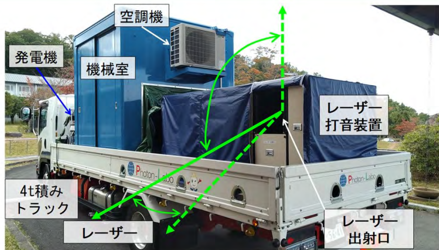
図4.2 レーザー打音検査装置 光が散乱するため、作業中は規制が必要
