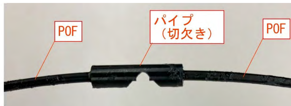
今期フィールド実証実験 使用センサ(予定)(市販パイプ)
