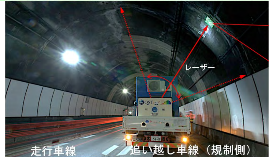
図4.2 レーザー打音検査装置 光が散乱するため、作業中は規制が必要
