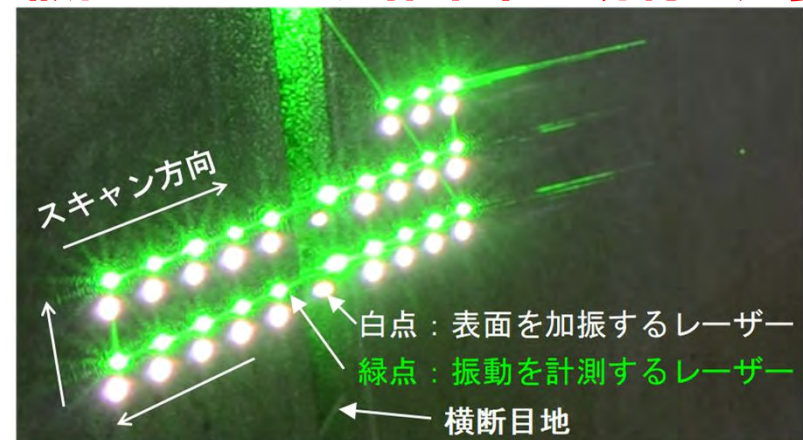
図4.2 レーザー打音検査装置 光が散乱するため、作業中は規制が必要
