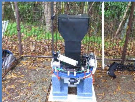
フロート式通水点検ロボット
