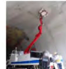
レーザー打音による変状の把握
