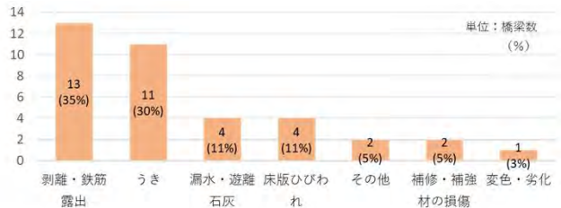
RC床版(鋼橋)の健全度Ⅲの損傷種別
