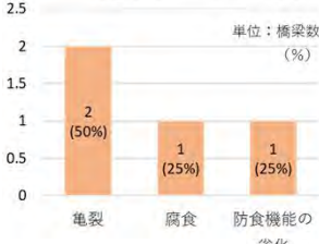
鋼床版の健全度Ⅲの損傷種別
