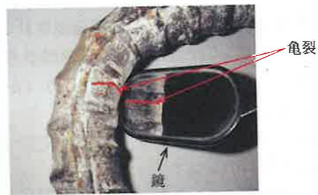
写真1 曲げ加工部の亀裂
