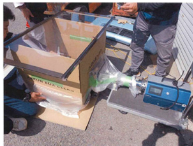
集塵機＋光触媒分解装置 入口側 測定状況
