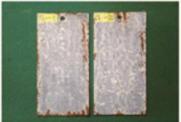
⑰レーザー除錆
