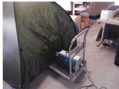
集塵機＋光触媒分解装置 出口側 測定状況
