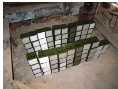
17号棟居室内 (飛来塩分がない環境)
