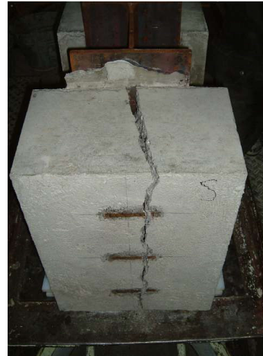
試験後の破壊状態 コンクリートが2つに分裂
