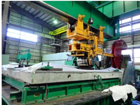
輪荷重走行試験の状況(補修供試体, 補修後)
