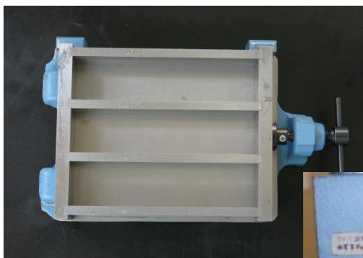
角柱供試体の型枠
