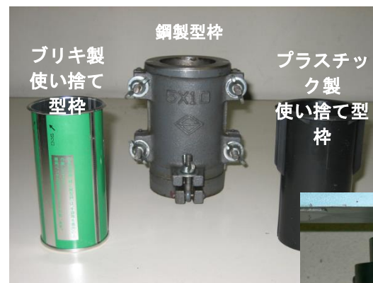
円柱供試体の型枠
