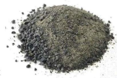
図3 石炭ガス化スラグ細骨材の製造工程 図4 石炭ガス化スラグ細骨材の外観
