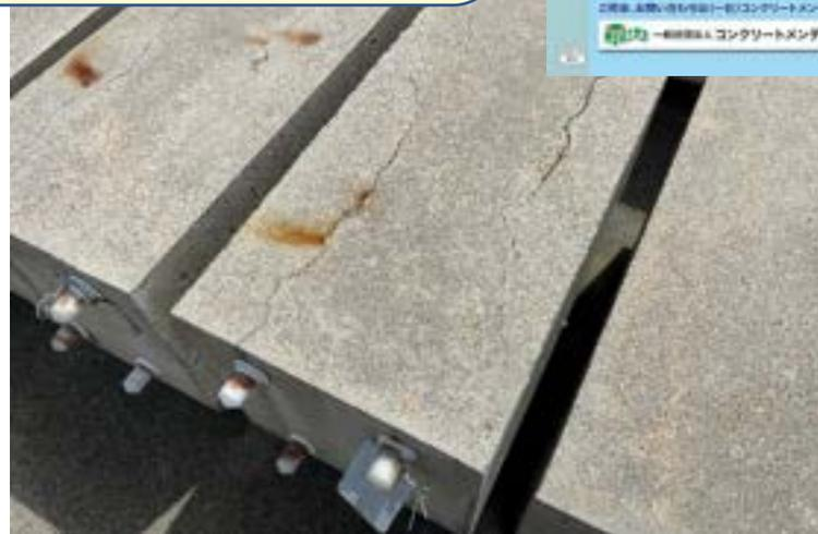
既設コンクリートの補修に関する実験に、弱材齢のコンクリート供試体を使用していませんか？劣化を生じた経年コンクリートを実験室で模擬、再現することは難しいですか？その供試体、コンクリートメンテナンス協会が作っておきました！
