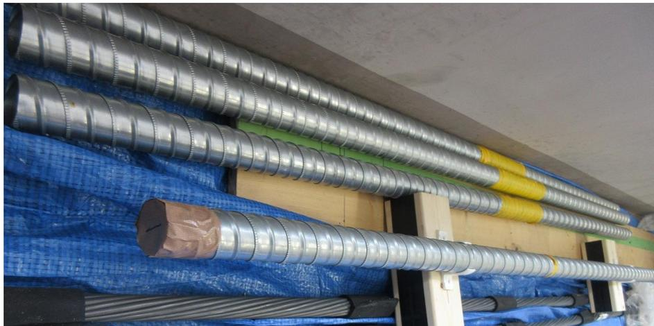
**シース内にPC鋼材を設置した試験体**
