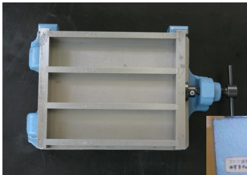
角柱供試体の型枠
