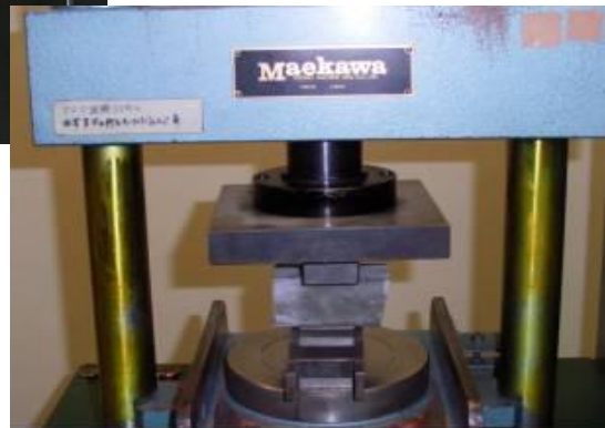
角柱供試体による測定状況
