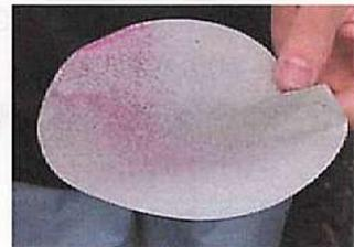
(5)呈色した段階でドリルを止めて、その時の深さをノギス等で測定し、中性化深さを判定する。
