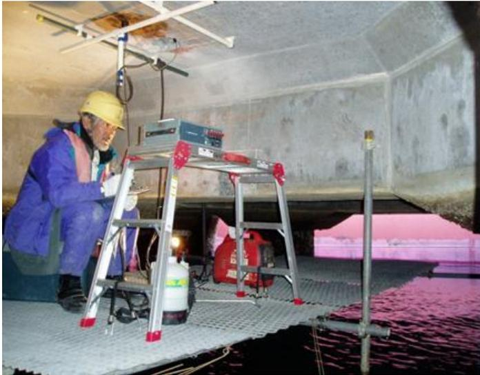
センサーをコンクリート表面に押し当てて分極抵抗を計測
