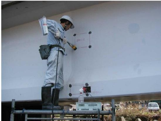
照合電極をコンクリート表面に押し当てて電位計測
