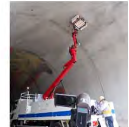
レーザー打音による変状の把握
