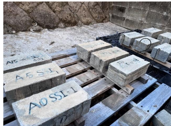
写真－2 断面修復後の曝露状況 (左 2 列半分はつり、右 2 列表面はつり)
