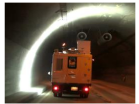
トンネル変状写真を 撮影する技術
