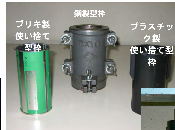
円柱供試体の型枠
