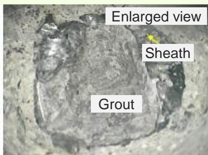
削孔+CCD 充填確認
