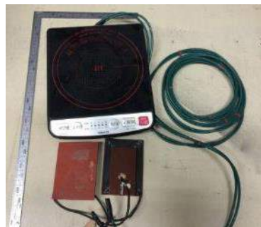
誘導加熱装置
