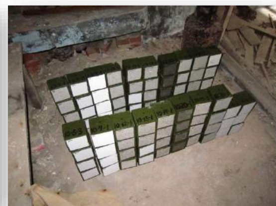
17号棟居室内 (飛来塩分がない環境)
