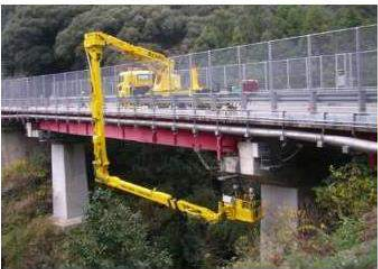
(従来：橋梁点検車による点検)
