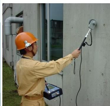
金属がその存在している環境で維持している電位のこと。鋼材が腐食するとき表面に腐食電池(アノード部とカソード部)が形成され、自然電位も変化する。
