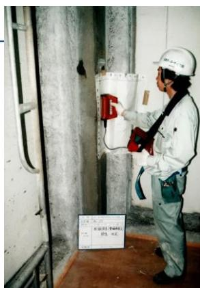
コンクリート表面に接触させるプローブに、交流を流し、磁界を作り、プローブを移動させることによる、磁界の変化により、鉄筋位置、径、かぶりを推定する。
