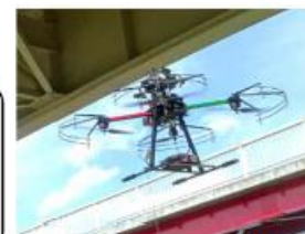
ドローンによる損傷把握
