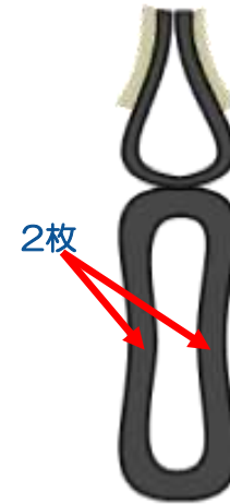
ゴムの壁が2枚なので圧縮時の幅が小さい
