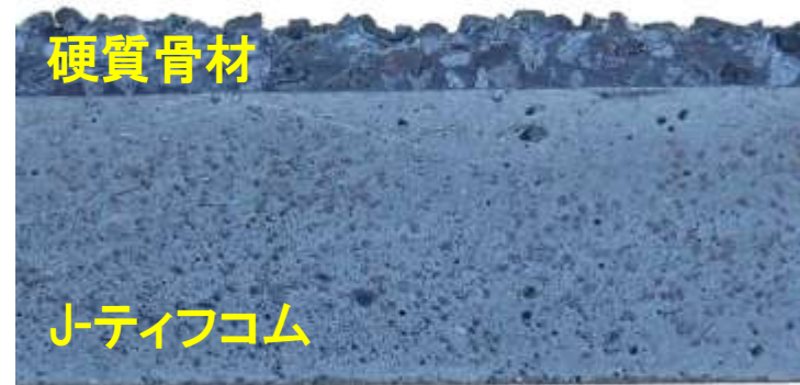
J-ティフコムと硬質骨材の接着断面
