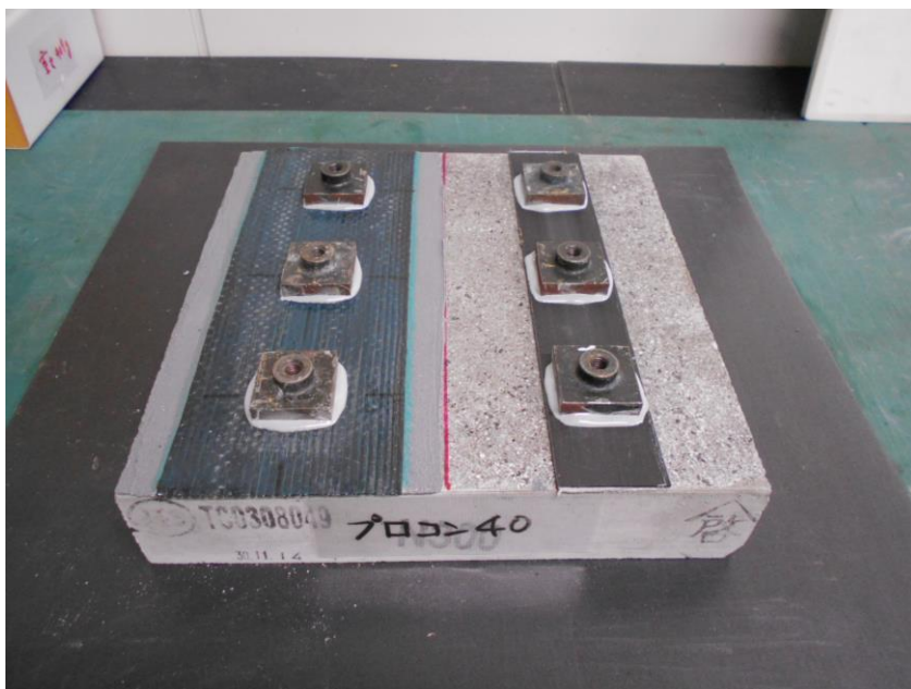
(4) アタッチメント取付完了
