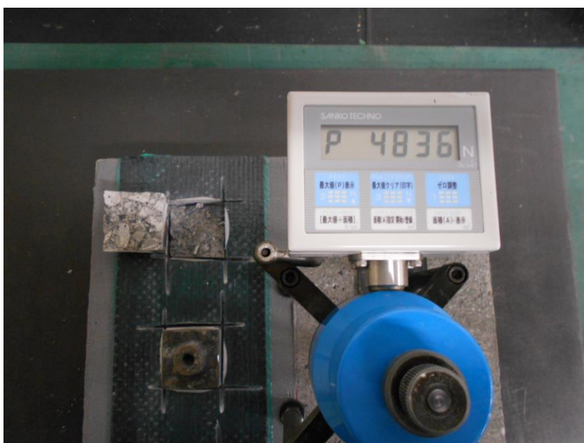
(5) 炭素繊維シート 接着試験 ① 最大荷重 4836N 接着強度 3.02N/mm 2
