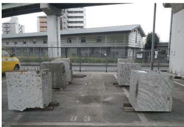
写真-7 圧入後の切り出し供試体の状況
