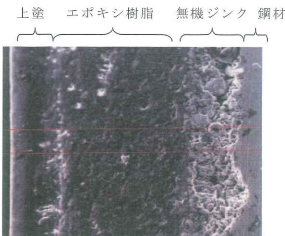
写真 4.3 SEM/EDX による塗膜断面写真
