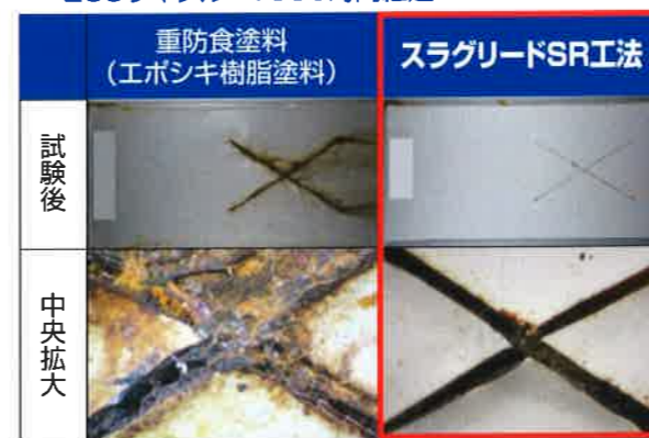
JIS H8502めっきの耐食性試験(中性塩水噴霧サイクル試験) 塩水噴霧(5%NaCl,35℃,2h)→乾燥(60℃,25%RH,4h)→湿潤(50℃,98RH,2h)
