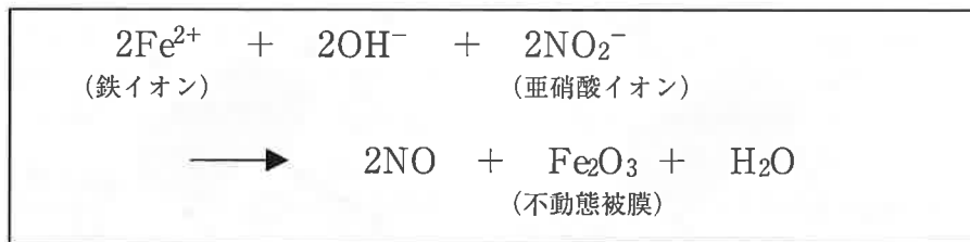
図2 亜硝酸イオンによる不動態皮膜再生の反応式
