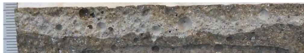
プライマー/プロコンガードS塗布品
