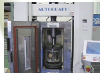
加熱状態での引張試験状況
