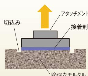
脆弱な下地モルタル板にアタッチメントを直接接着し、破断強さ試験を実施。
