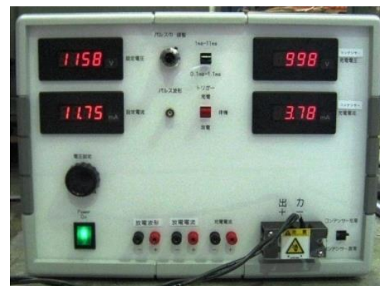
定電圧定電流発生装置
