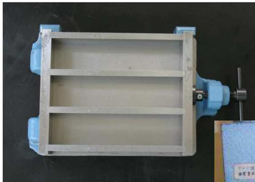
角柱供試体の型枠
