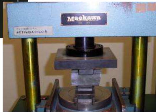
角柱供試体による測定状況
