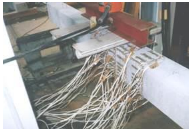
ひずみゲージ取付け 曲げ試験中
